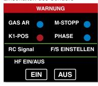
Beim Einschalten des Senders wird die Position des an Ausgang 1 (Fläche) bzw. Ausgang 6 (Heli) angeschlossenen Gasservos überprüft. Befindet sich das Servo außerhalb des Leerlaufbereichs, bleibt das HF-Modul abgeschaltet.
