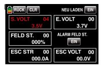
Die Senderakkuspannung ist während des Betriebs im LCD-Display zu überwachen. Bei Erreichen einer in der Zeile "Warnschwelle Akku" des Untermenüs »ETC. SET« des Systemmenüs,, einstellbaren Spannung, standardmäßig 3,6 V (Lith.) beim Sender mz-24 PRO HoTT, ertönen akustische Warnsignale und im Display erscheint ein Warnfenster.
