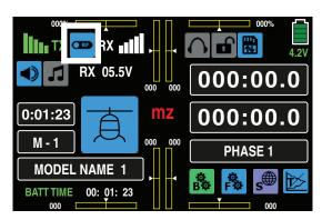
Das daneben befindliche rote "RX" und grüne "TX" bedeuten, dass der aktive Modellspeicher bereits an einen *Graupner*-Empfänger gebunden wurde, aber keine Verbindung zum Empfänger besteht.
